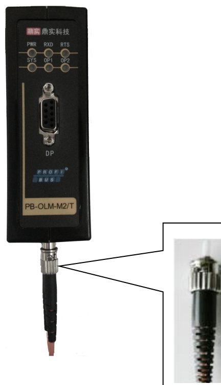
图 2-8 PB-OLM-M2/T 光纤插头安装图
