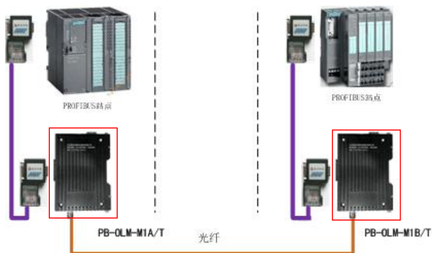
图 1-5、采用单根光纤进行点对点组网
