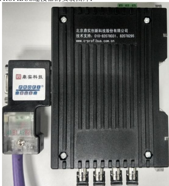
图 2-6、PROFIBUS 连接器安装
